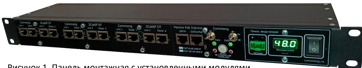
Рисунок 1. Панель монтажная с установленными модулями
